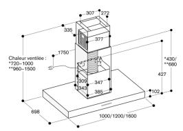
Avec la cheminée pour recyclage AD 442 116 adaptée pour des hauteurs de plafond allant de 2,35 m à 2,60 m.
