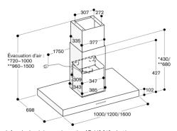
\* Avec la cheminée pour évacuation AD 442 016 adaptée pour des hauteurs de plafond allant de 2,35 m à 2,60 m. \* 'Avec la cheminée pour évacuation AD 442 026 adaptée pour des hauteurs de plafond allant de 2,60 m à 3,10 m; les chiffres se réfèrent aux mesures entre le sol et le bord inférieur de la cheminée de 1,60 m.
