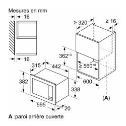
Mesures en mm Installation d'un micro-ondes de 20 I dans un placard haut
