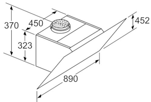
Appareil en mode circulation d'air sans canal
