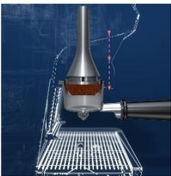
La technologie « Smart Tamping Station » assure un tassage parfait sans la moindre difficulté et en toute propreté. Il suffit d'abaisser le levier latéral pour appliquer la pression optimale sur la mouture, à chaque préparation.
