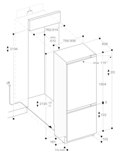
Les dimensions maximales de la façade de la porte comprennent un entrebaillement de 3 mm.
