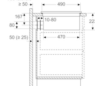
En cas d'installation directement contre des murs extérieurs qui ne sont pas isolés ( $\mu \geq 0,5 \text{ W/m}^2 \cdot \text{°C}$ ), nous recommandons d'utiliser des configurations de recyclage partiellement ou totalement gainées.
