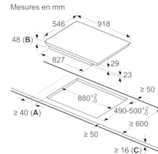
**A:** Distance minimum entre la découpe de la plaque de cuisson et le mur.
