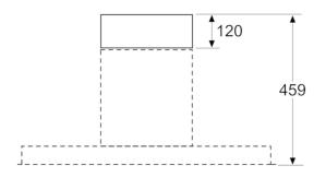
Le conduit peut être monté directement sur l'appareil ou en combinaison avec une tablette.
