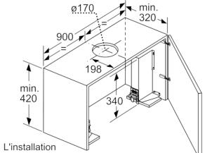
d'une hotte tiroir de 90 cm dans un meuble haut d'une largeur de 90 cm requiert un kit d'installation. Les deux équerres d'installation sont vissées à droite et à gauche dans le meuble. Installation selon gabarit.
